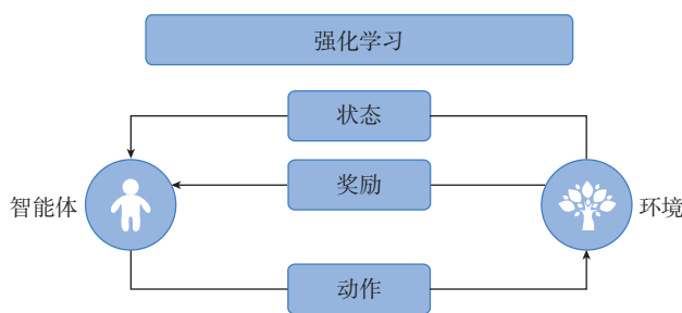
图 3.4.3 强化学习用于决策问题的通用模型示意图
